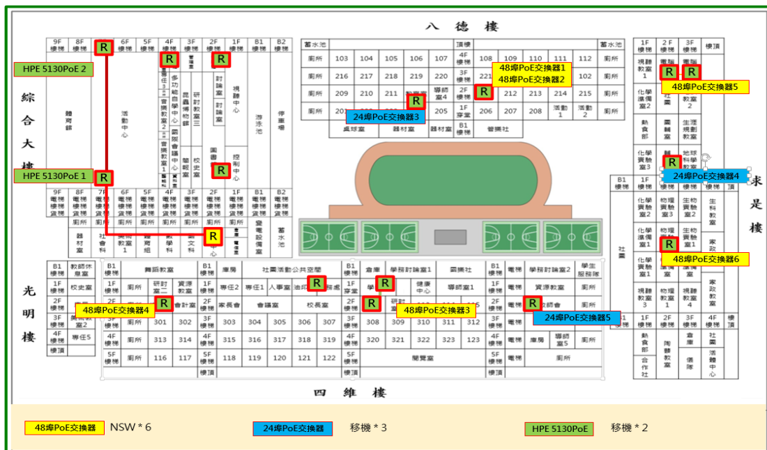
臺北市成功高級中學- 光纖、交換器汰換示意圖
